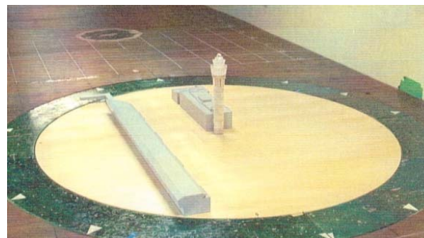
風洞実験による風荷重評価
