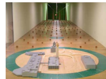
模型を用いた風洞実験
