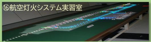
航空灯火システムの実習室では、500分の1の飛行場模型や航空灯火の 実機が展示されています。
