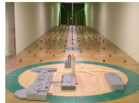
模型を用いた風洞実験
