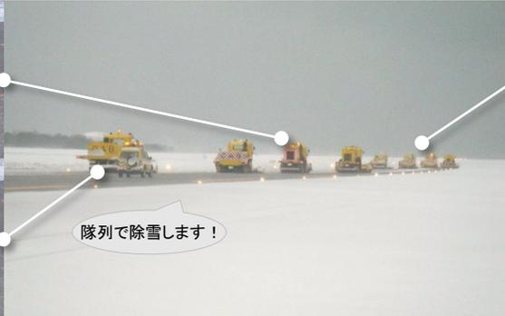
路面の雪を高速で跳ね飛ばし、雪を移動させる作業に使用する車両。
