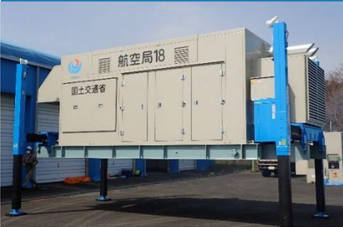
自然災害をはじめ航空保安施設等における電源障害時の電源確保のため展開される運搬が容易な発電設備。
