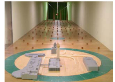
模型を用いた風洞実験
