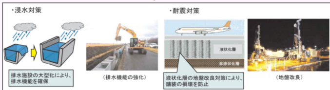
空港の防災・減災、国土強靱化、耐災害性対策
