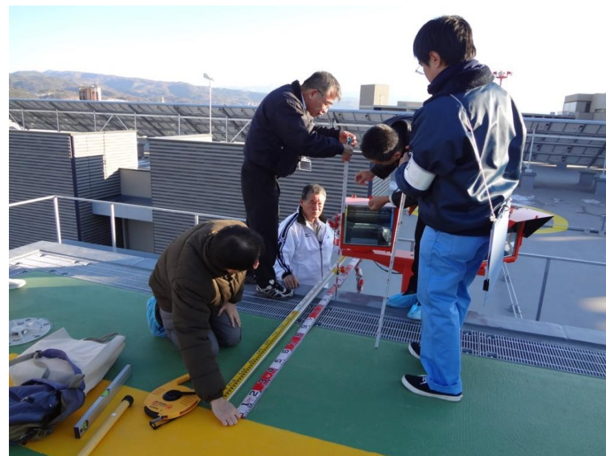
航空法に基づく制限値を満たしているか検査している様子 （佐久医療センターヘリポート（長野県））
