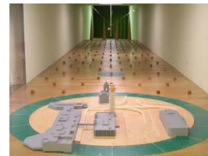
模型を用いた風洞実験
