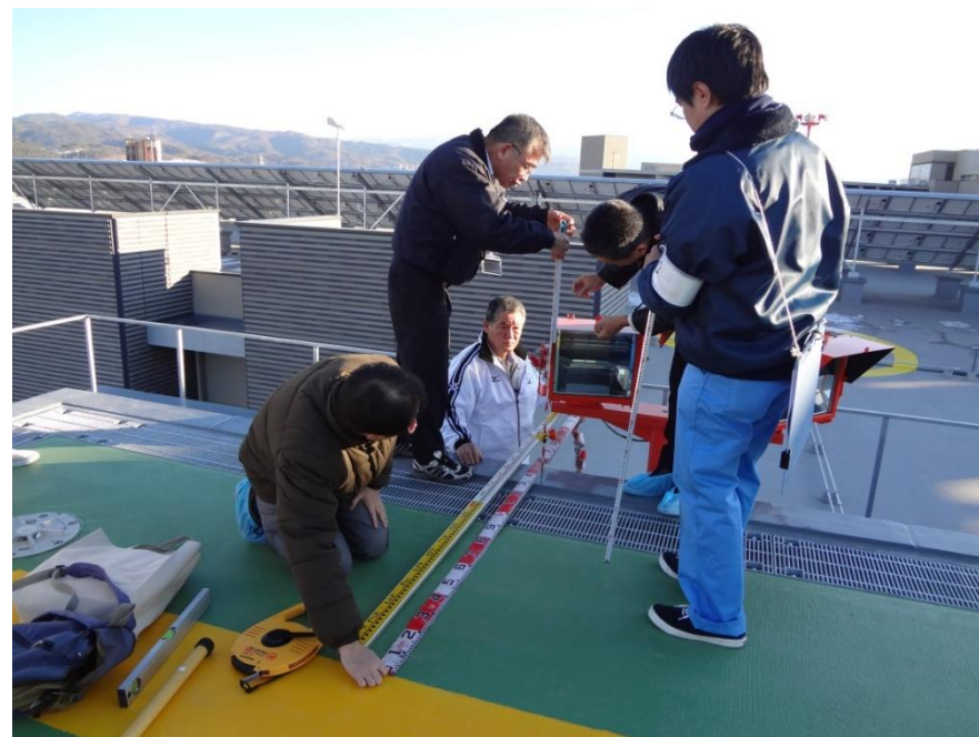
航空法に基づく制限値を満たしているか検査している様子 （佐久医療センターヘリポート（長野県））
