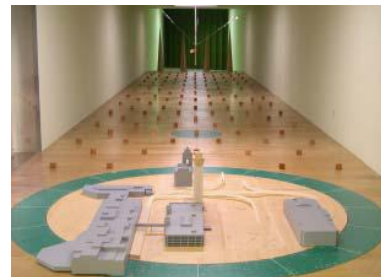
模型を用いた風洞実験
