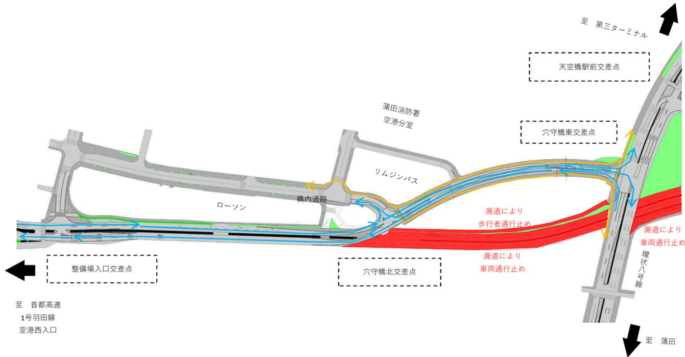
環状八号線部 工事完了後車両導線
