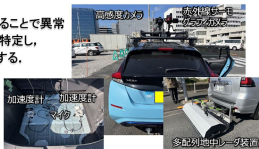
センサを搭載した巡回点検車両
