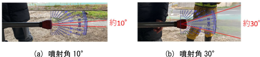
図-2.15 洗浄水の拡散状況
