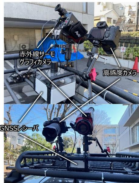
図-4.10 車両におけるセンサー設置状況①
