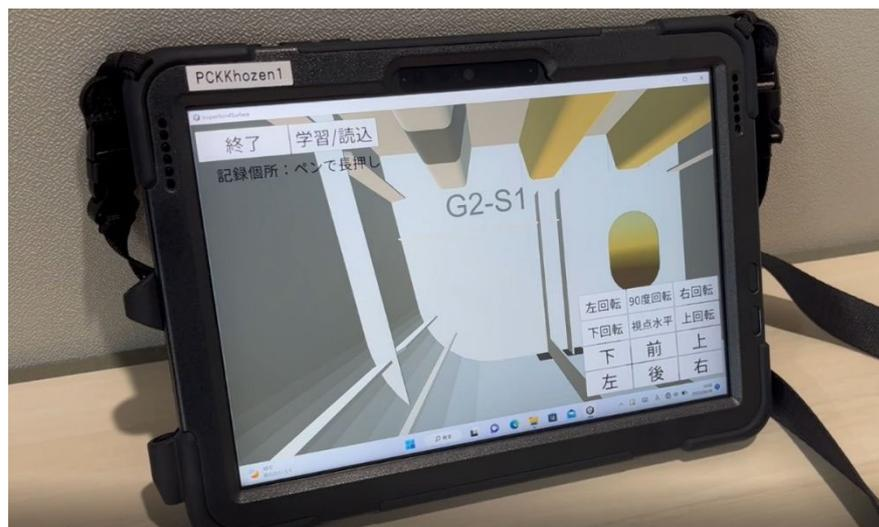
図-4.3 3D デジタル点検野帳を実装した点検端末
