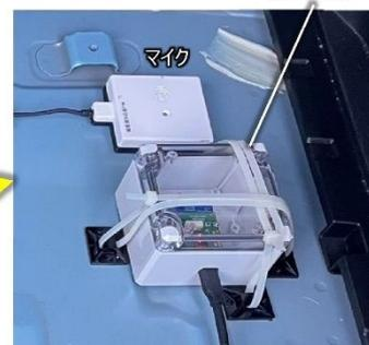
図-4.11 車両におけるセンサー設置状況②
