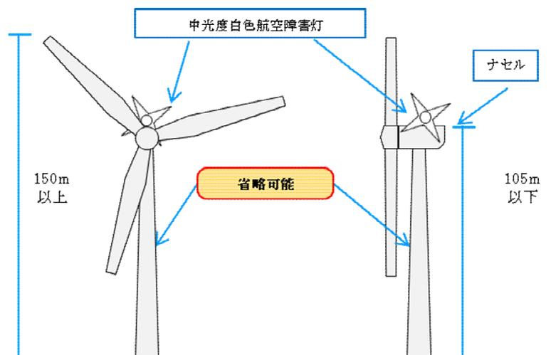
図5-29 風力発電設備群を構成する高さが150m以上かつナセル頂部が105m以下の高さの風力発電設備に設置する低光度航空障害灯の省略
