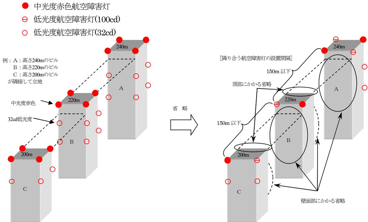
図5-20 隣接による省略／低光度化
