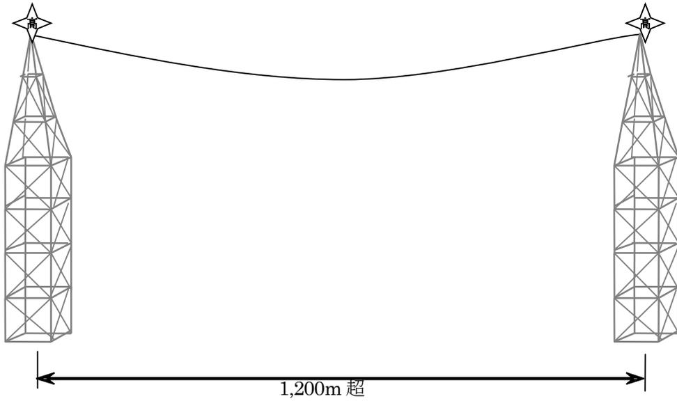
支持物件の物件の水平間隔1,200m超の場合
