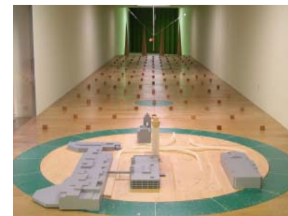
模型を用いた風洞実験
