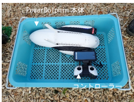
図ー 9.2.9 水上ドローン外観および調査状況
