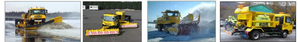
ブラウ除雪車      スーパー除雪車      ロータリ除雪車      凍結防止剤散布車
