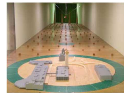
模型を用いた風洞実験
