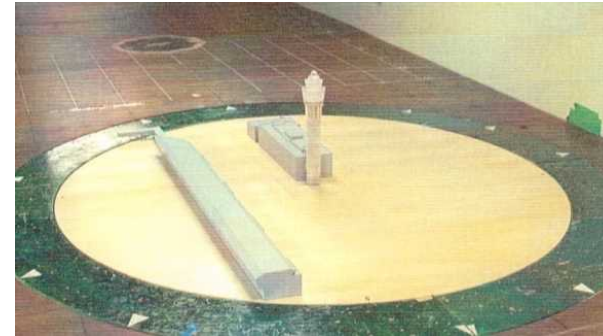
風洞実験による風荷重評価
