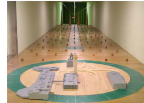
模型を用いた風洞実験
