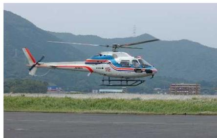
全長：12.90m 全幅：10.7m 高さ：3.1m
