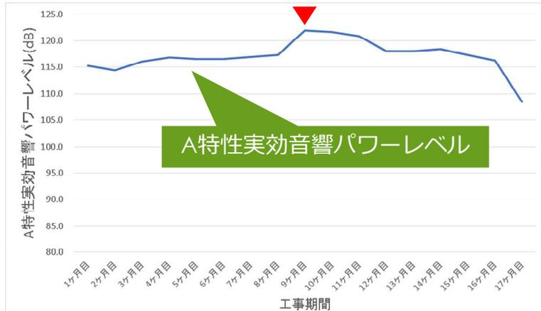
A特性実効音響パワーレベル：各建設機械の実効騒音レベルから、伝播理論式により建設機械ごとの音響パワーレベルを求め、それらを稼働台数分合成したもの。
