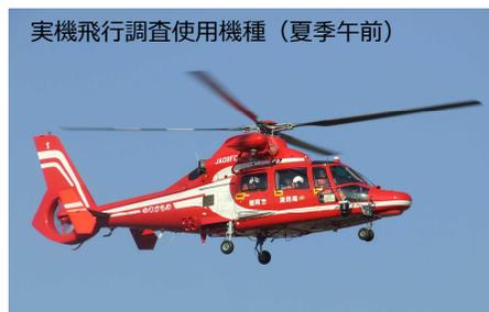
全長：13.7m 全幅：11.9m 高さ：3.8m
