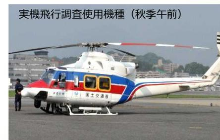
全長：17.1m 全幅：14.0m 高さ：4.6m
