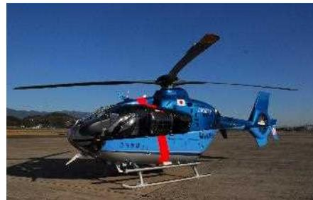
全長：12.2m 全幅：10.2m 高さ：3.5m
