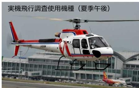
全長：12.9m 全幅：10.7m 高さ：3.2m
