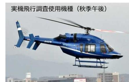
全長：13.0m 全幅：11.3m 高さ：3.8m
