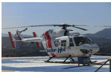
全長：13.0m 全幅：11.0m 高さ：4.0m
