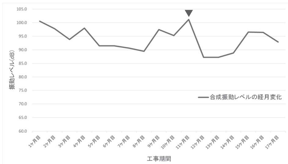
図 8.5.2-4 建設工事の実施に伴う合成振動レベルの経月変化
