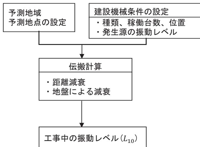
図 8.5.2-2 建設工事の実施に伴う建設工事振動の予測手順
